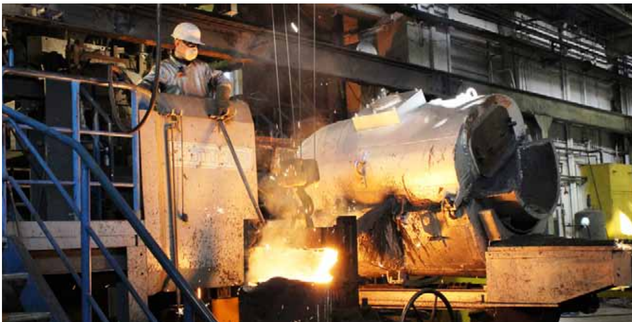
Процесс плавки: забор жидкого чугуна из вагранки
