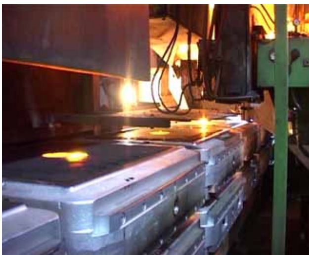
Формовочная линия: литьё в песчаные формы
