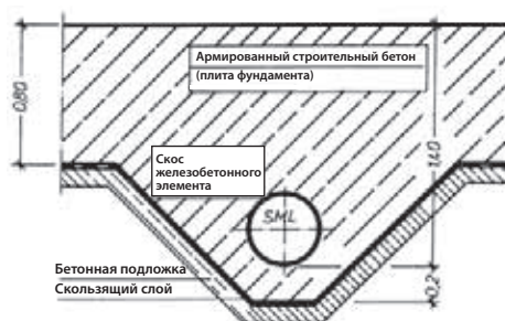
Утолщение в плите фундамента
