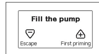
Нажав на “+”, система переходит в процедуру наполнения: начинает работать в течение максимум 5 минут, во время которых не срабатывает блокировка из-за работы без воды. Время наполнения зависит от нескольких параметров, самым важным из которых являются глубина уровня воды для всасывания, диаметр всасывающего канала, герметичность всасывающего канала. При условии использования всасы-
