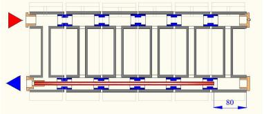
Удлинители потока **VT.503** выпускаются в правом (D) и левом (S) исполнении для подключения трубопроводов или арматуры с диаметром условного прохода 1/2" и 3/4".
