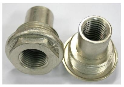
Удлинитель потока **VT.503** является оптимальным решением для многосекционных радиаторов с односторонним подключением, и позволяет устранить проблему прогрева только нескольких секций радиатора, расположенных ближе к точкам подключения.
