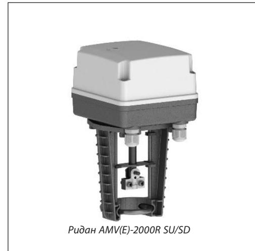
Электроприводы AMV(E)-2000R SU/SD предназначены для управления регулирующими клапанами импульсным или аналоговым сигналом от электронных регуляторов Ридан ECL-3R/4R или подобных в системах центрального теплоснабжения, отопления, вентиляции и кондиционирования воздуха.
