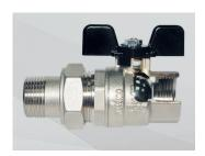
Шар проходит алмазную полировку и покрыт хромом, корпус имеет дополнительное покрытие из слоя никеля, обеспечивающего высокую коррозийную устойчивость и долгий срок службы.
