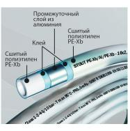
Металлопластиковые трубы STOUT отличаются превосходными эксплуатационными характеристиками, сочетая в себе преимущества металлических и пластиковых труб. Конструкция трубы состоит из двух слоев сшитого полиэтилена (PE-Xb), между которыми располагается слой из алюминиевого сплава.
