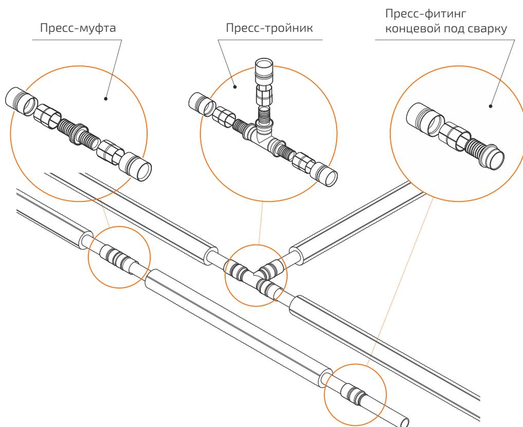
Рис. 1.2.3. Виды фасонных изделий для монтажа труб ИЗОПРОФЛЕКС-115А
