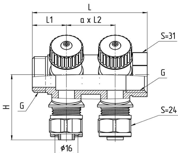
Рисунок 2 – Габаритные размеры коллектора
