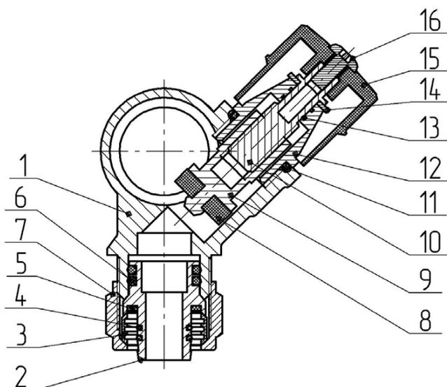
Рисунок 1 – Конструкция коллектора с регулирующими клапанами
